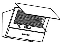
**ВНИМАНИЕ!** В зависимости от варианта монтажа используйте самонарезающие винты и дюбели, соответствующие типу стены (например: железобетон, гипсокартон и т.д.). Если винты и дюбели входят в комплект поставки, следует удостовериться в том, что они подходят для того типа стены, на которой должна быть смонтирована кухонная вытяжка.
